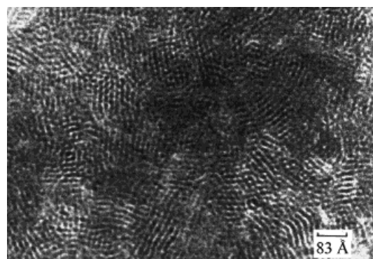
Abb. 2. TEM-Aufnahme von Nb-TMS6 (nicht calciniert, Synthesebedingungen siehe Legende zu Abb. 1). Diese Aufnahme wurde mit einem JEOL-002B-Transmissionselektronenmikroskop (200 kV Beschleunigungsspannung) gemacht.
